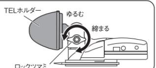
TELホルダーの角度調節は、吸盤クレイドルのロックツマミを少し緩め、調節します。角度調節する際は、必ずスマートフォンをはずした状態で行なってください。(17ページ参照)
