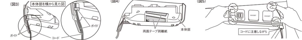
**5** コードを配線します。まず、運転席側内装パネルのツメ(2箇所)を慎重にはずし、運転席側内装パネルを開きます(図6)、はずしたツメがはまっていた穴(2箇所)の後ろ側にコードを通すように配線し(図7)、運転席側内装パネルを元に戻します。
