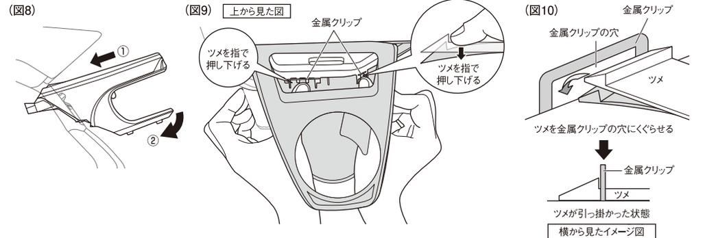
**9** 金属クリップ小・大にツメがしっかり引っ掛かっていることを確認し、両面テープがシルバーパネルに密着するように押さえ付けて一度でしっかりと貼り付けます。(図6・図7)
