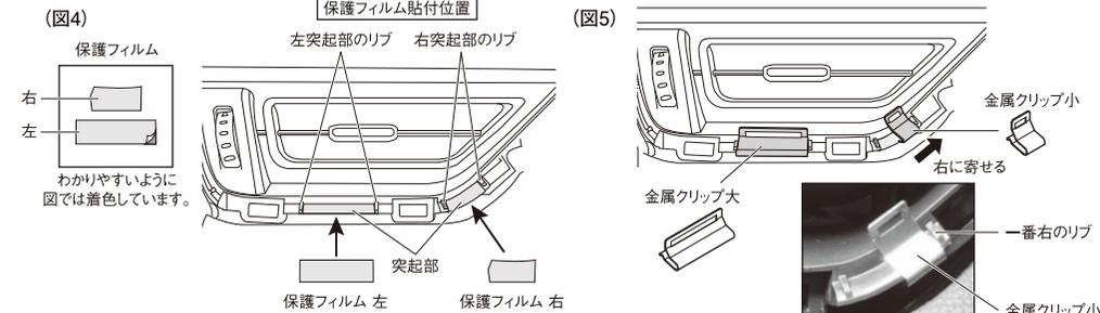
**6** 本体をあてがって(図2)本体背面のツメの位置(2箇所)と金属クリップ小・大の穴の位置が合っていることを確認します。金属クリップがズレないように注意しながら、シルバーパネルを元に戻します。(図6・図7)
