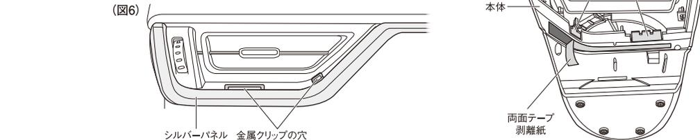
**8** エアコンフィンを上に向けて上側にすき間をつくり(図2)、本体上側を挿し込んで(図8-①)、本体にあるツメ2箇所(図7)を指で押し下げながら(図9)、金属クリップの穴(図6)にくぐらせるようにして引っ掛けます。(図8-②・図10)
