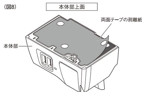
**2** 本体部を取り付けます。本体部上面の両面テープが貼付場所以外に貼り付かないように注意しながら、**1**で確認した取付場所に一度でしっかりと貼り付けます。コードをフロントコンソールと本体部の間に挟まないよう本体部背面のガイドに注意しながら図9のように下からしっかりと押さえつけてください。
