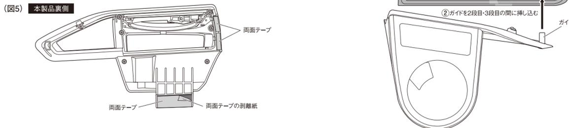
**5** 両面テープが貼り付かないように注意して図7のように本製品のエアコンフィン調節穴の右端をノブの右側に軽く当てます。図8のように本製品の右端に指をかけて軽く押しながら本製品の上部を車両パネルに沿わせるように右にスライドさせ(図8-①)、本製品の左上角を上から押しつけてしっかりとします。(図8-②)
