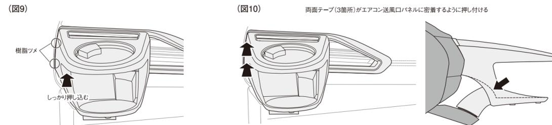
**車両用補強パーツの取付方法** 脱落を防止するため、必ず車両用補強パーツを貼り付けてください。
