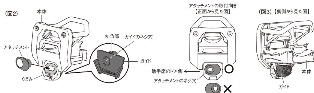
**4** アタッチメントとガイドが落下しないように注意しながら本製品を助手席乗降グリップ左側(図1)にのせます。ガイドの丸凸部をゴムキャップを取りはずした穴に合わせ、アタッチメントのネジ穴からワッシャー→スプリングワッシャー→六角ボルトの順に挿し込み、六角レンチ(8mm)等を使用して締めます。(図1・図4)
