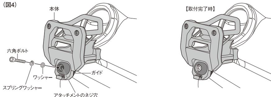
**5** 本体が傾かないように手で抑え、水平に保ちながら増し締めをします。増し締めを強くし過ぎると車両内装側が破損するので、本体を固定できる程度にしてください。(図5)
