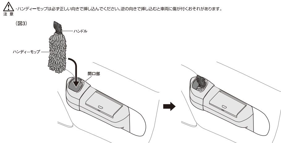
△ 注意 ハンディーモップは必ず正しい向きで挿し込んでください。逆の向きで挿し込むと車両に傷が付くことがあります。
