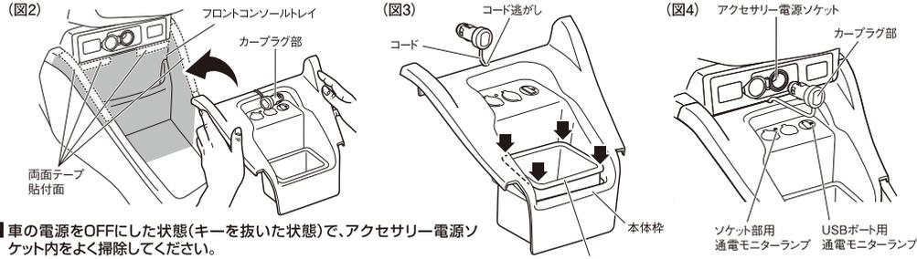
**4** 車の電源をOFFにした状態(キーを抜いた状態)で、アクセサリ電源ソケット内をよく掃除してください。
